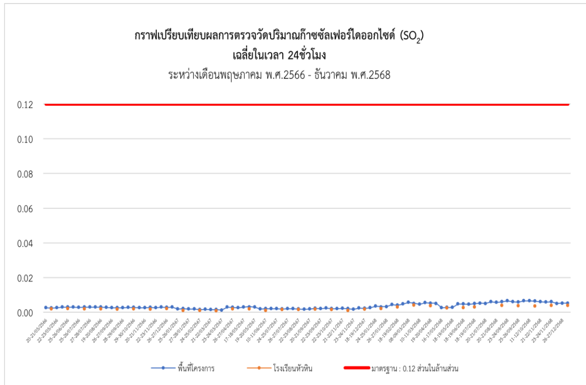
รูปที่ 4-14 กราฟเปรียบเทียบผลการตรวจวัดปริมาณก๊าซซัลเฟอร์ไดออกไซด์ (SO 2 ) เฉลี่ย 24 ชั่วโมง ระหว่างเดือนพฤษภาคม พ.ศ.2566 ถึงเดือนธันวาคม พ.ศ. 2568
