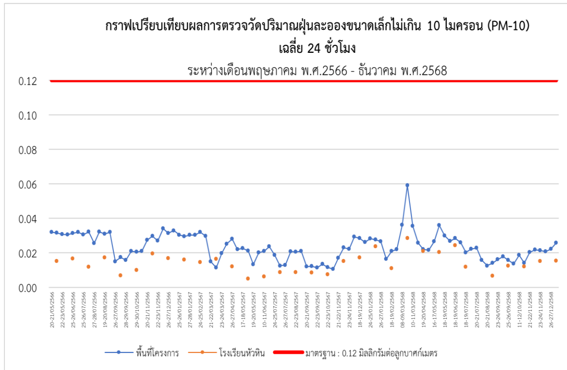
รูปที่ 4-10 กราฟเปรียบเทียบผลการตรวจวัดปริมาณฝุ่นละอองขนาดเล็กไม่เกิน 10 ไมครอน (PM-10) เฉลี่ย 24 ชั่วโมง ระหว่างเดือนพฤษภาคม พ.ศ.2566 ถึงเดือนธันวาคม พ.ศ. 2568
