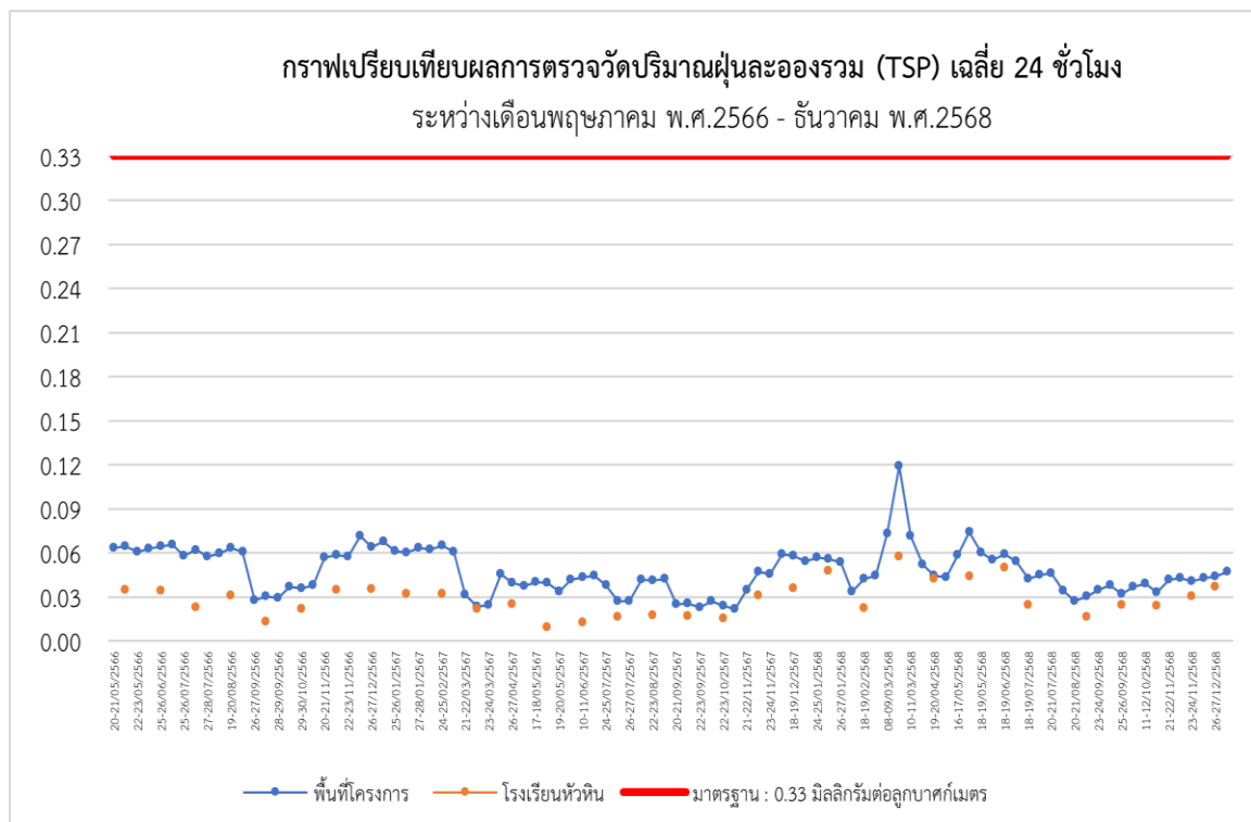
รูปที่ 4-9 กราฟเปรียบเทียบผลการตรวจวัดปริมาณฝุ่นละอองรวม (TSP) เฉลี่ยในเวลา 24 ชั่วโมง ระหว่างเดือนพฤษภาคม พ.ศ.2566 ถึงเดือนธันวาคม พ.ศ. 2568
